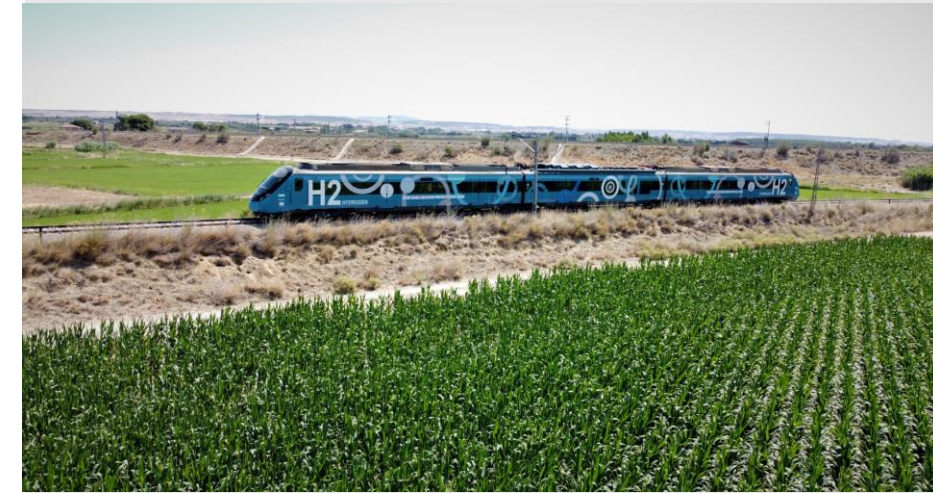
28/07/2022. Pruebas dinámicas en vía del prototipo de tren de hidrógeno del proyecto FCH2Rail, desarrollado por el consorcio de empresas formado por CAF, DLR, Toyota, Renfe, ADIF, CNH2 y Stemmman-Technik.
